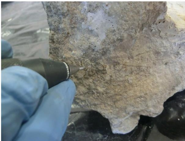
Remoção de cimento-cola com micro-martelo ultrassônico.
