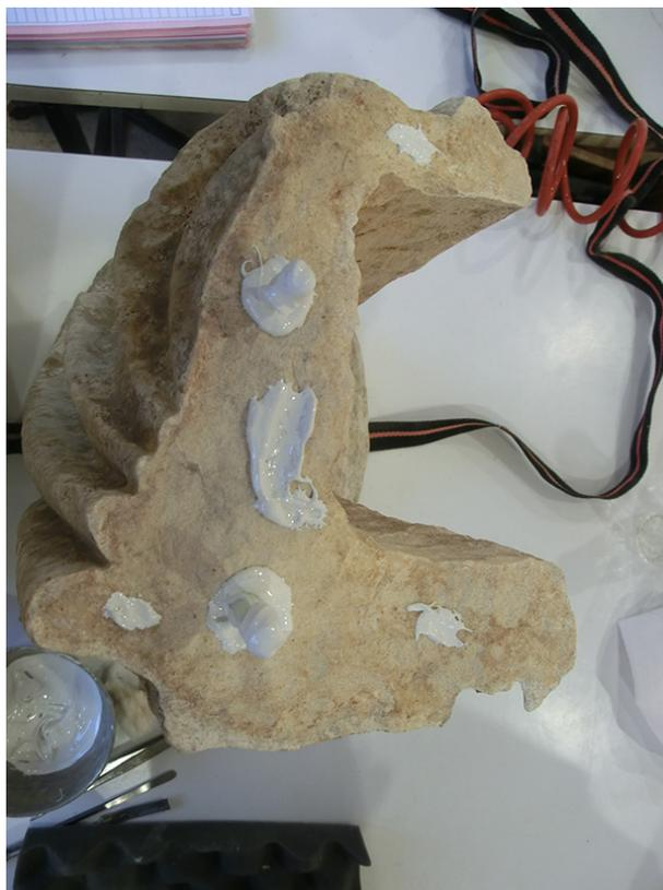
Colocação de pontos de resina e de espigões de reforço.
